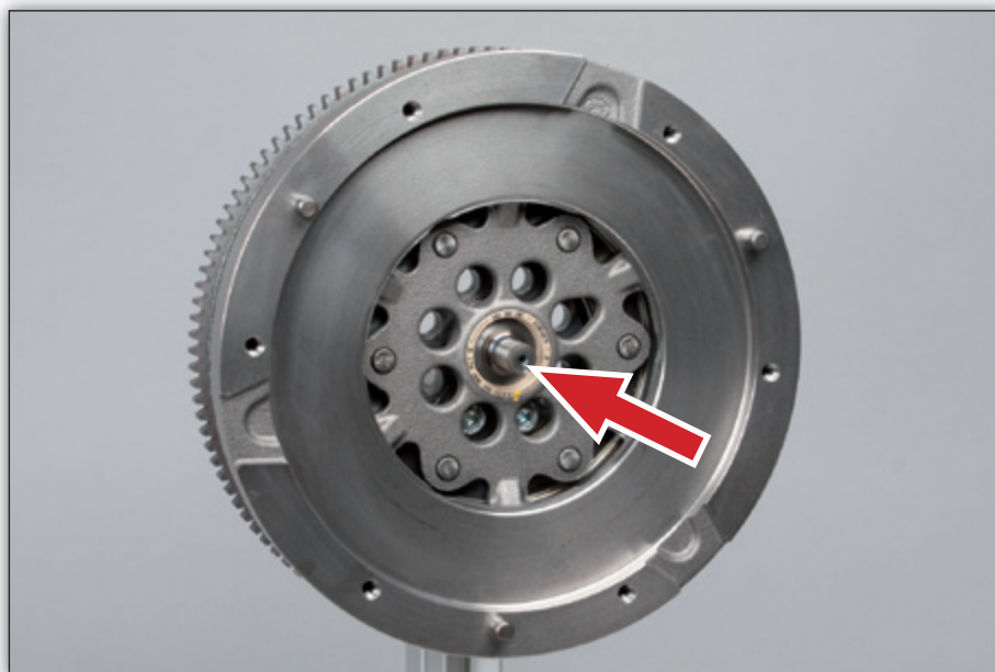
Fig. 1: Espigão guia do volante bimassa 415 0377 10
