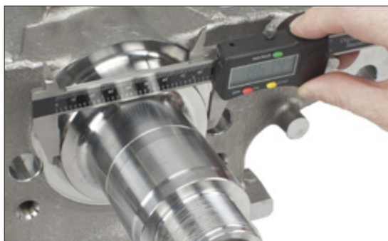
Fig. 2: Para determinar qual dos três anéis de segurança é o mais ajustado, deve medir-se o diâmetro da transmissão no ponto indicado
